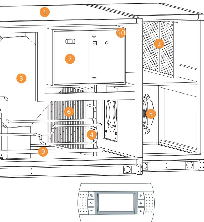
La capacità termica erogata dal gruppo in pompa di calore sarà modulata in continuo attraverso la variazione di velocità del compressore frigorifero del tipo DC brushless rotativo o scroll.
